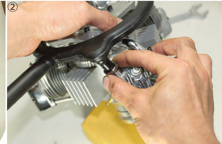
② リングマフラーナットを全てのシリンダーに軽くねじ込みます。3つ全て、指でスムーズに回るように位置を合わせて下さい。無理やりにねじ込むと、シリンダーを破損します。 ②Insert 3 nuts of the ring muffer into each cylinder. Adjust position that all threads can be turned smoothly by your fingers. Never tighten by force, or you may break the cylinders.
