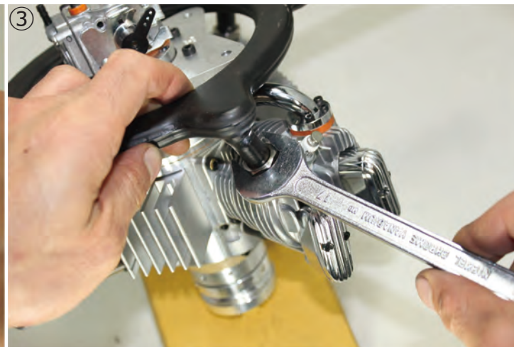
③ スパナでリングマフラーのナットを締めこみます。3つを均等に、徐々に締めこんで下さい。 ③Evenly and gradually tighten up each nut of the ring muffer by a spanner.
